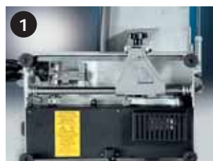
1 - Protezione inferiore Underside motor protection plate
