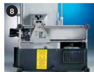
8 - Protezione inferiore Underside motor protection plate
