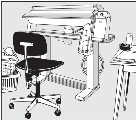
Необходимо обеспечить горизонтальное положение и достаточную устойчивость гладильной машины (чтобы она не скатывалась вбок).
